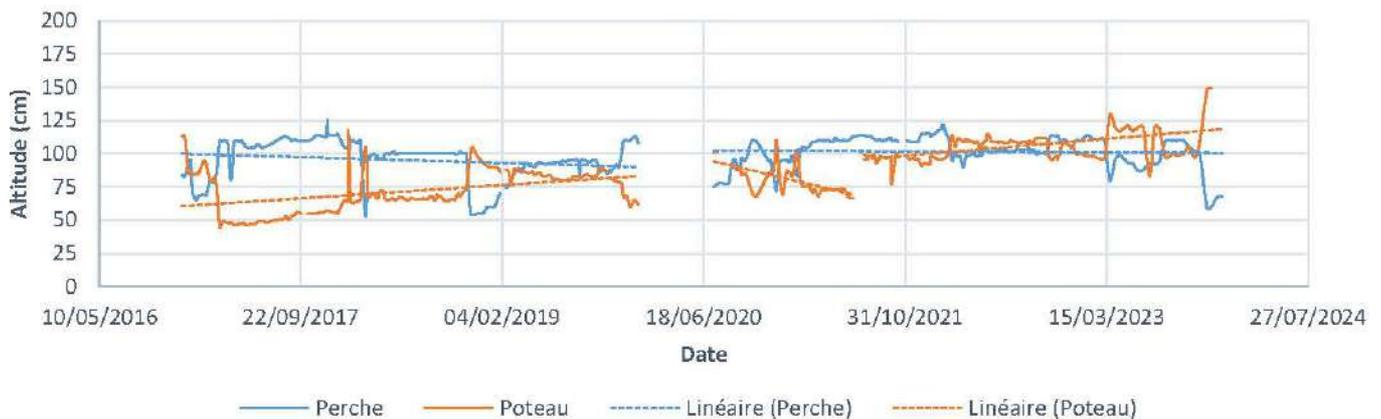
Les niveaux de sédiment sur l'enrochement sont généralement stables depuis le début du suivi, montrant une légère propension à l'érosion au niveau du poteau extérieur. Les récents coups de vent ont provoqué l'une des variations les plus importantes jamais enregistrées par ce suivi, avec une diminution du sédiment d'un demi-mètre du côté de l'enrochement.
