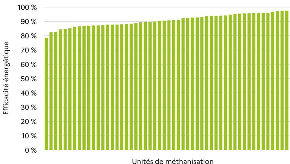
$$\frac{\text{Énergie injectée}}{\text{Énergie primaire}} = \text{Efficacité énergétique}$$
