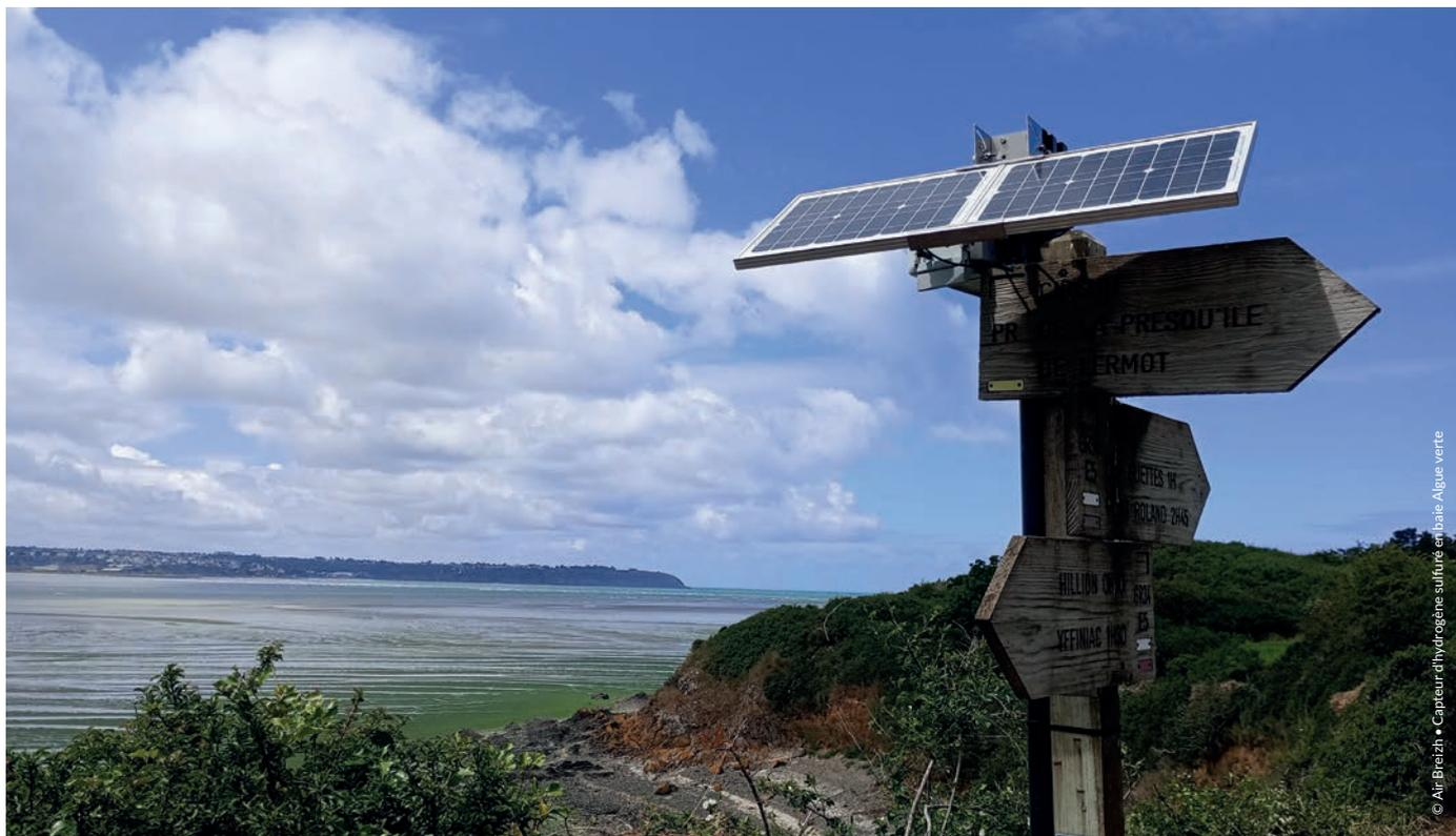
© Air Breizh • Capteur d'hydrogène sulfuré en baie Algue verte
