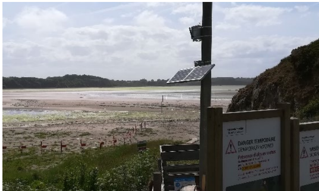
Capteur H 2 S sur l'un des points de mesure
