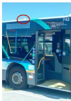
Implantation du boîtier AQMO sur un bus « Kéolis Rennes »
