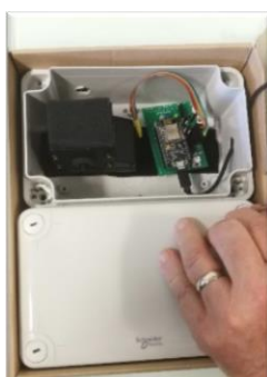
Détail du boîtier AQMO (microcapteur OPC-N3 et contrôleur)
