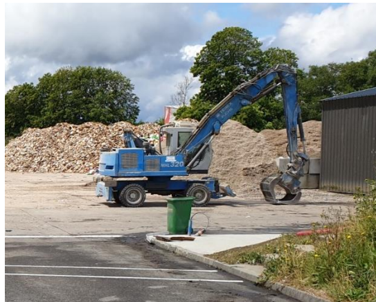
Source possible d'émissions de poussières sur le site de tri-valorisation de déchets : stockage et manipulation des refus de tri
