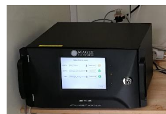
L'analyseur de carbone suie à Pays-Bas est un aéthalomètre. Son taux de couverture en 2019 est de 96%.
