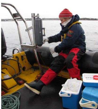
Prélèvement d'un échantillon d'eau avec une bouteille Niskin (photo : Aourégan Terre Terrillon)
