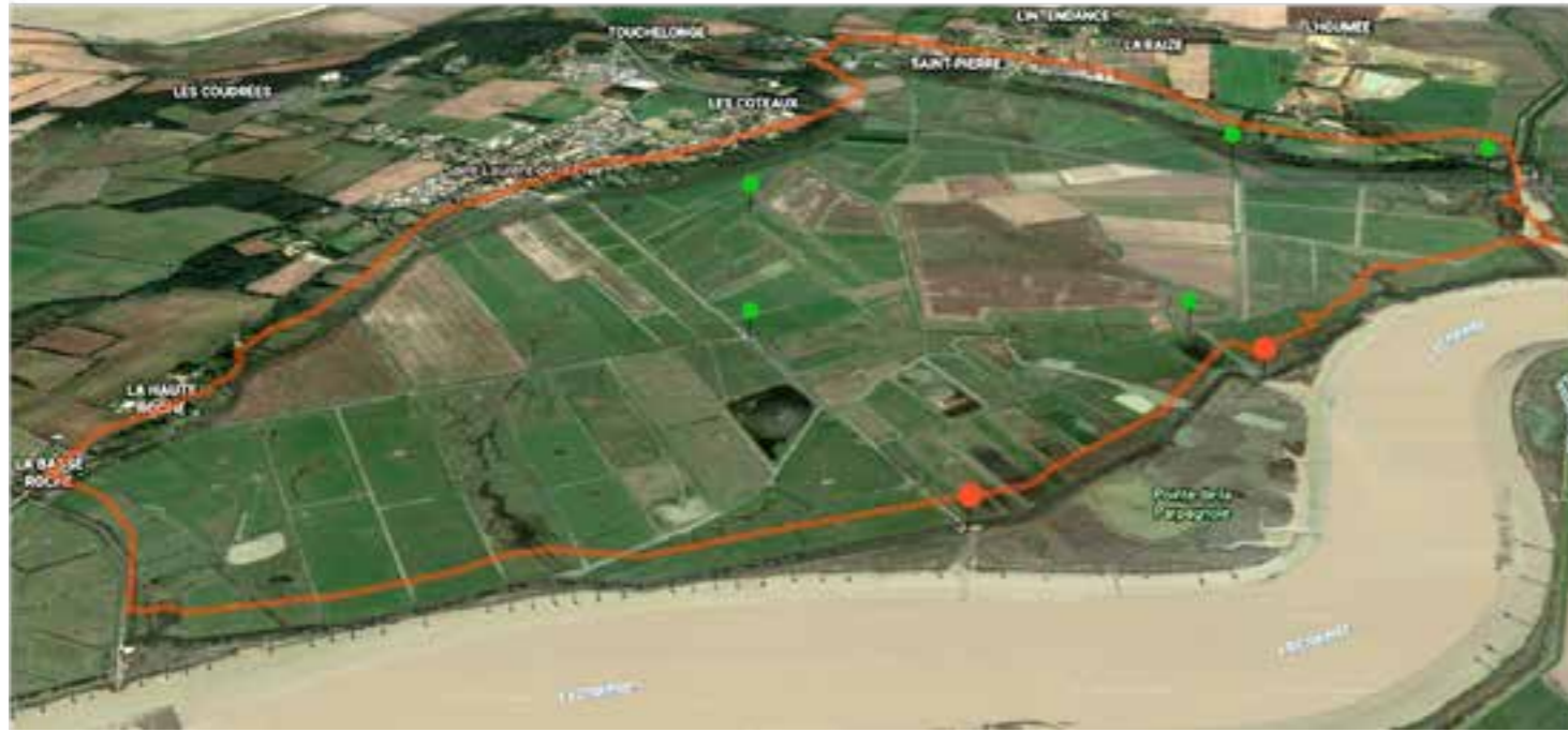
Exemple de cartographie de délimitation d'une UHC sur le marais de Saint-Laurent-de-la-Prée, Rochefort Nord. Points orange : ouvrages de communication vers l'extérieur de l'UHC, en bleu ouvrages internes à l'UHC (Source : Google Earth®, modélisation et composition FMA)
