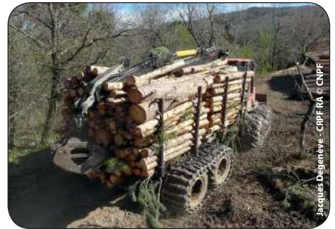
Porteur équipé d'un "kit chenille" autour des roues pour améliorer la portance en milieu fragile
