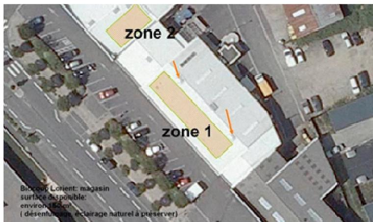
Cette surface permettrait d'installer une centrale photovoltaïque de 25 à 30 kWc, pour une production annuelle d'environ 26 à 31 MWh.
