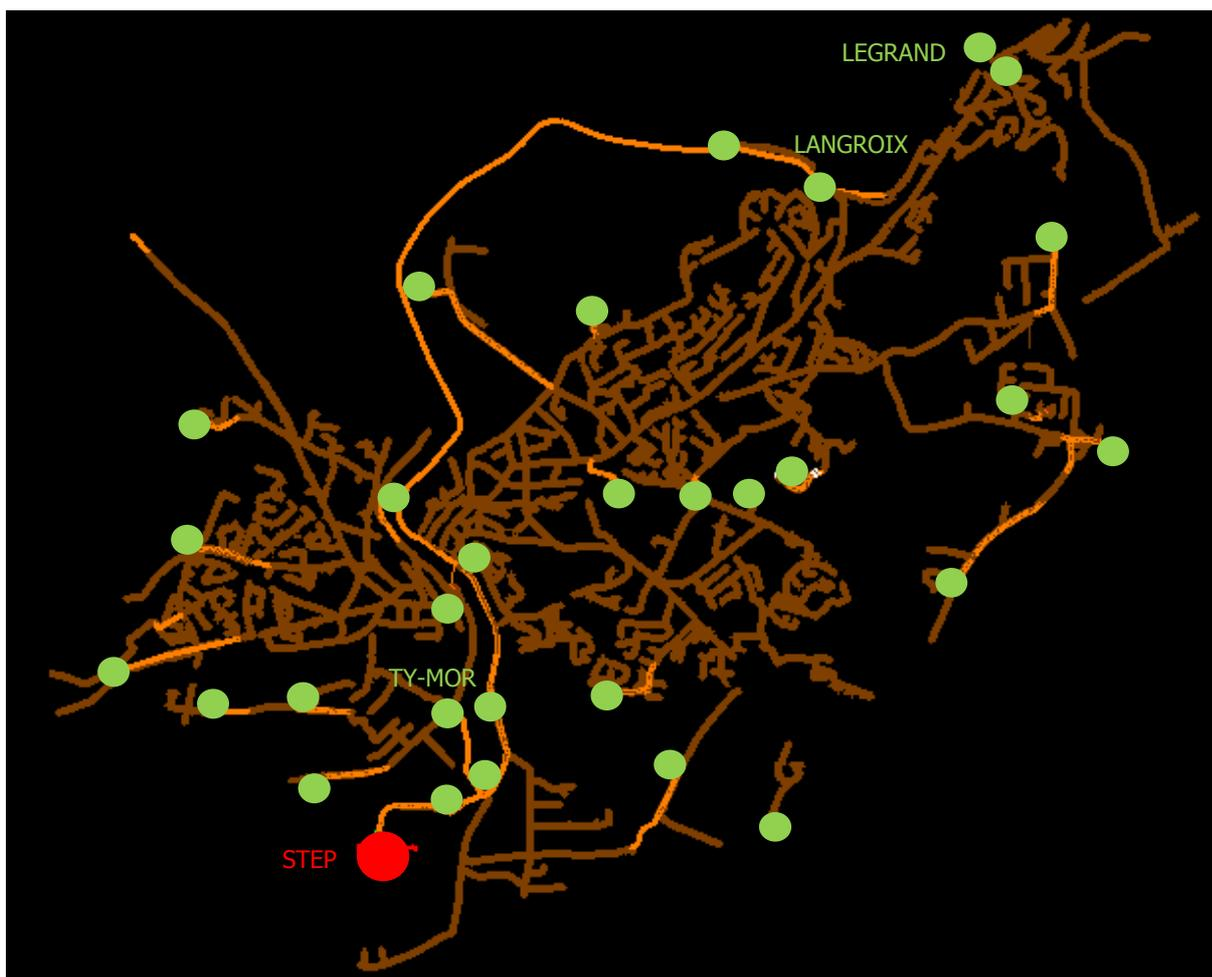
Les réseaux en marron sont les réseaux gravitaires et ceux en orange sont les réseaux de relevage. Les points verts de la carte représentent les stations de relevage, et la STEP apparaît en rouge.
