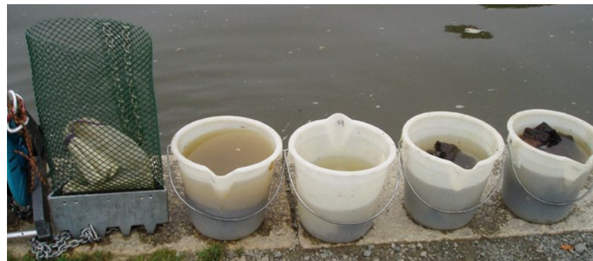
Les 4 prélèvements effectués dans le chenal à l'aide d'une drague (sur 12 prélèvements au total)
