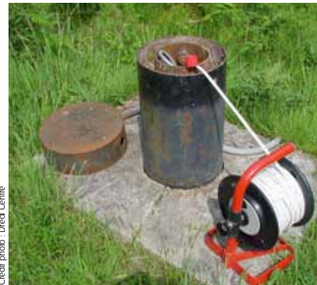
Le piézomètre est un outil de mesure qui indique le niveau de la nappe d'eau souterraine.
