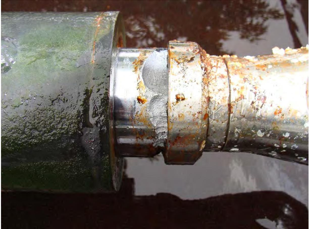
Figure 13.- Résultat de la corrosion électrolytique sur l'une des tiges de vérin de la porte aval de la passe à bassins.
