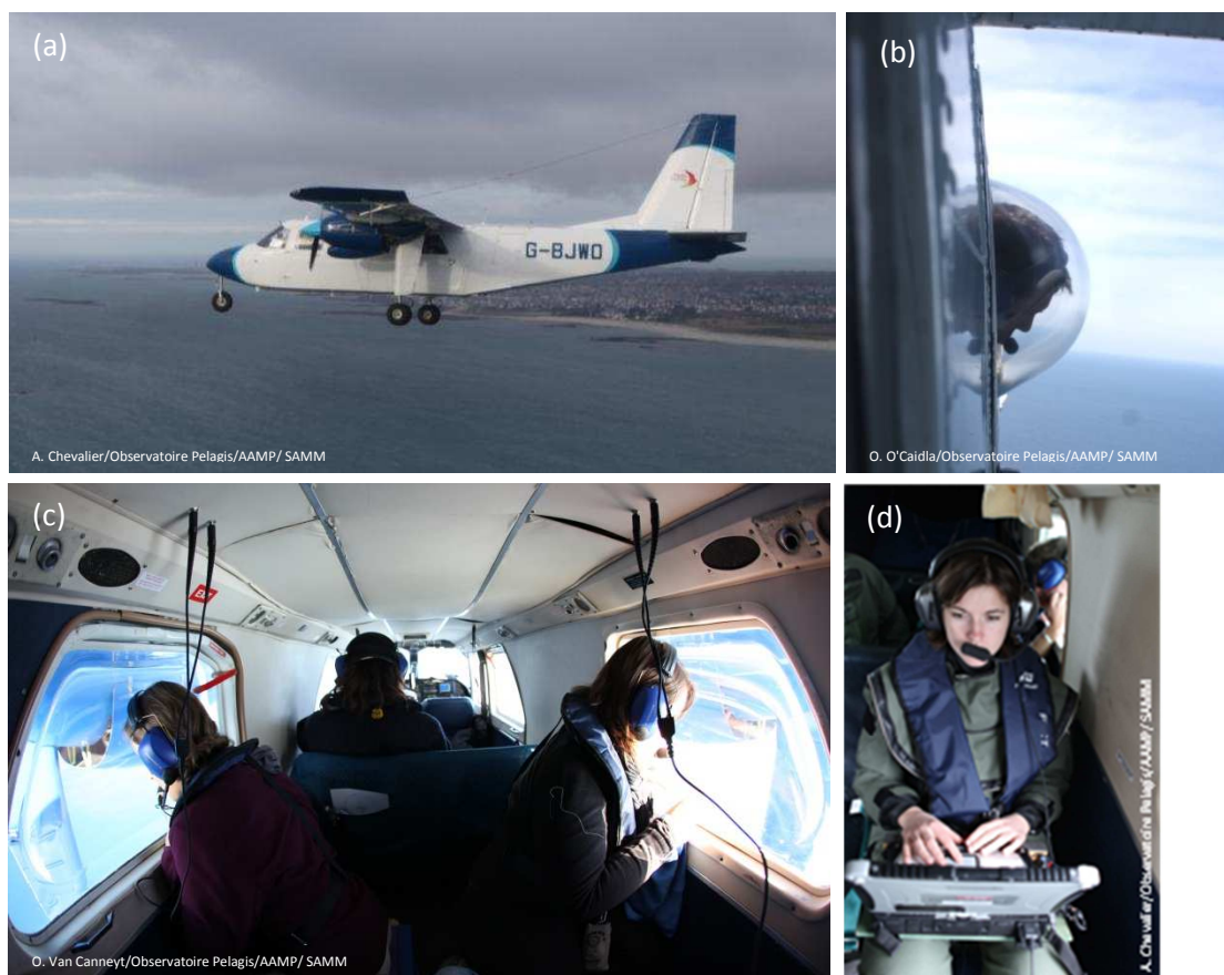
Figure 2 (a) Avion à ailes hautes de type BN2; (b) hublot-bulle ; (c) postes d'observation ; (d) saisie des données et navigation.
