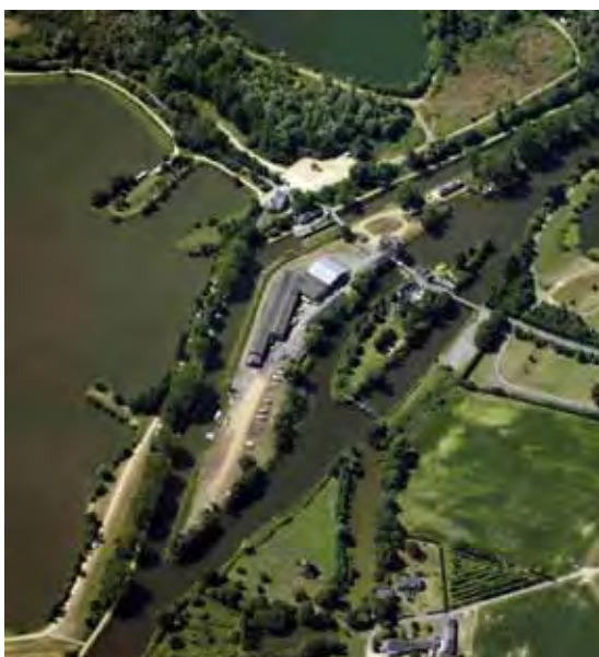
Moulin d'Apigné : ponts, écluse, moulin, barrage, bief, port, l'ensemble du vocabulaire fluvial se rassemble sur un espace contraint.
