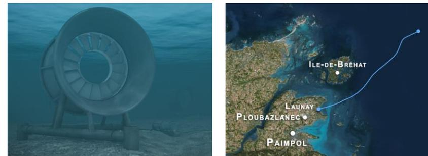
Figure 62 : Schéma de la future hydrolienne du parc de Bréhat et tracé du raccordement
