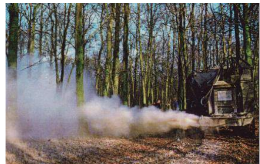
Figure 38 : Epandage avec tracteur équipé d'une turbine, Photo Université catholique de Louvain
