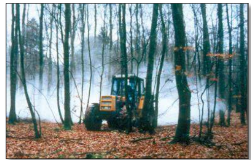
Figure 37: Epandage avec tracteur équipé d'un semoir rotatif, photo de l'ONF
