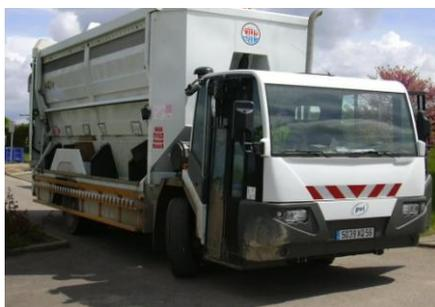
Pour vider la benne en fin de collecte, un système de cloison mobile permet la vidange des compartiments, indépendamment et par ordre chronologique dans des caissons de réception, correspondant à chaque catégorie d'emballage recyclable.
