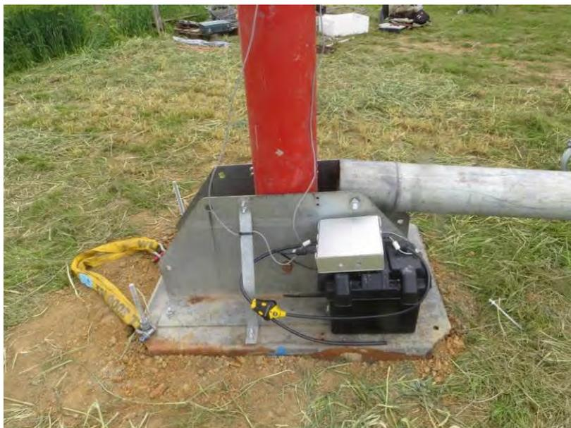
Installation de l'enregistreur et de sa batterie au pied du mât de mesure.
