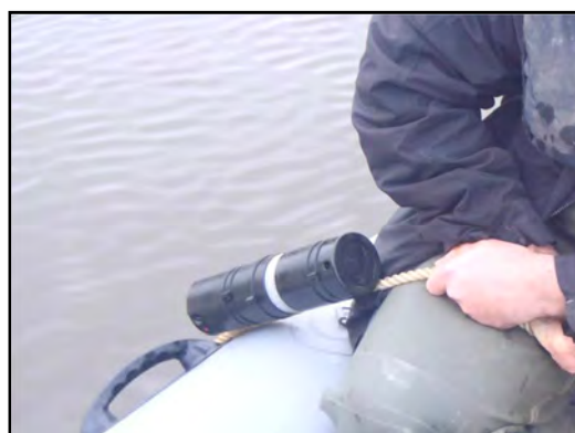
FIGURE 67 : HYDROPHONE MIS EN PLACE SUR LA RETENUE DE BOIS JOLI (FISH PASS).
