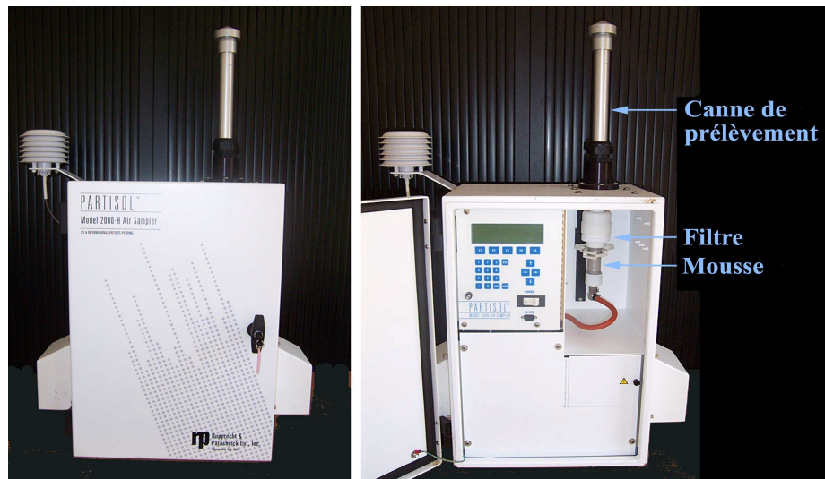
Fig.6 : Système utilisé pour prélever les pesticides dans l'air
