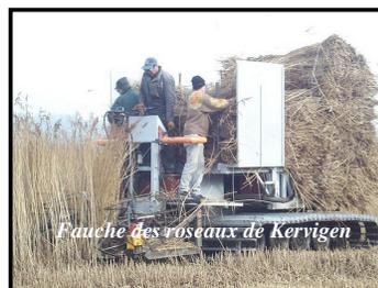
La faucheuse est une ancienne dameuse à neige, réadaptée pour une utilisation en zones humides. Quasiment tous les équipements d'origine ont été modifiés, des chenilles plus larges, une benne pour stocker les bottes de roseaux et une faucheuse/lieuse à l'avant qui servait à l'origine à récolter le riz.
