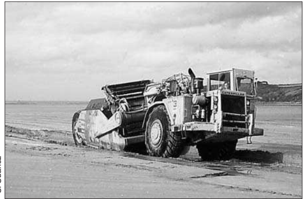
Ouverture du chenal artificiel du Yar à l'aide d'un engin de type "éploveur".
