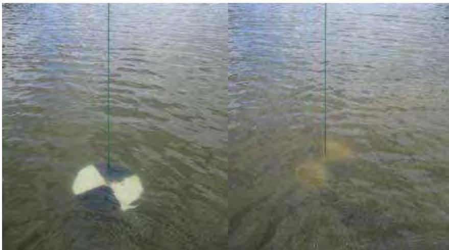
Figure 33 : Mesure de transparence au disque de Secchi
