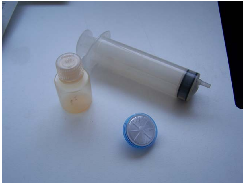
Figure 33. Les trois accessoires requis pour la préparation d'un échantillon d'eau en vue d'une analyse COD.
