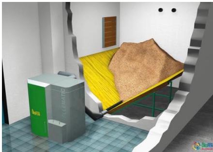
Pièce de réserve avec alimentation par vis (source ÖkoFEN)
