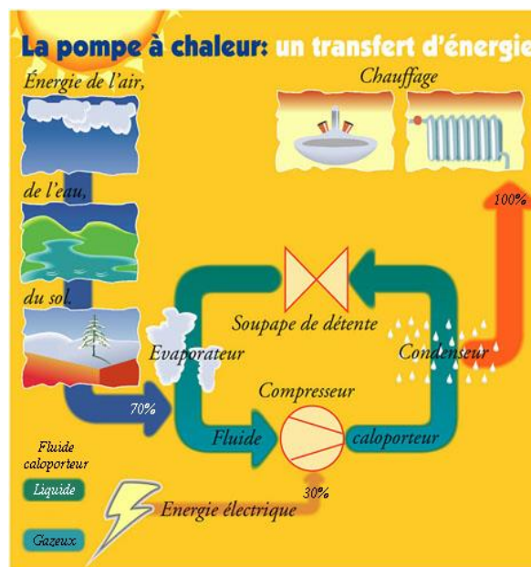
Figure 55 : principe de fonctionnement des pompes à chaleur (source www.airclim-concept.com )
