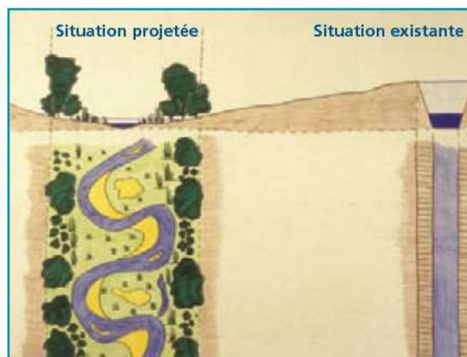
Figure 23: Remise dans le talweg (GGDL, 2007)
