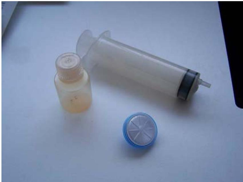
**Figure 14.** Les trois accessoires requis pour la préparation d'un échantillon d'eau en vue d'une analyse COD.
