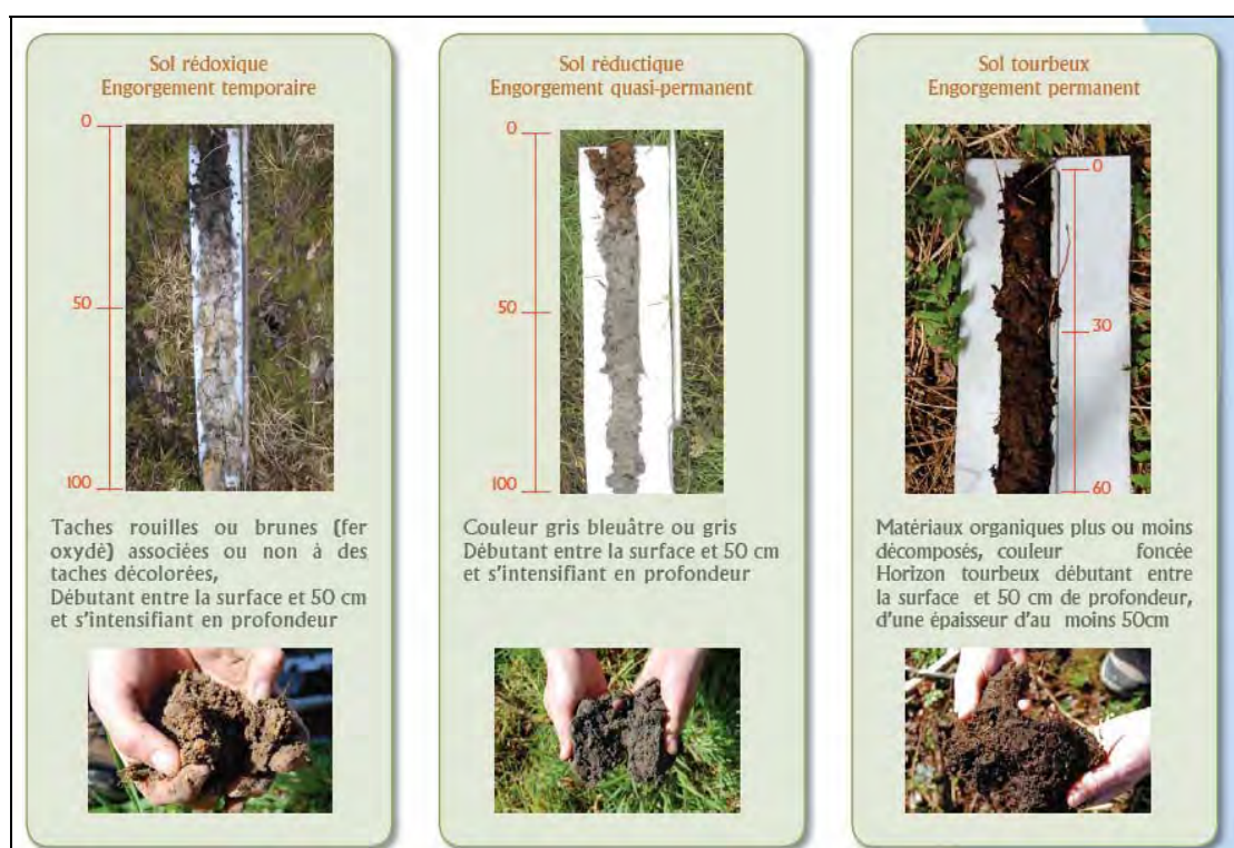
Figure 8 – Illustrations du caractère hydromorphe des sols (Source : « Guide technique Inventaire des zones humides à l'échelle locale sur le département du Finistère », Version du 22.04.2009, édité par Le Forum des Marais Atlantiques et le Conseil Général du Finistère, pages 23-24)
