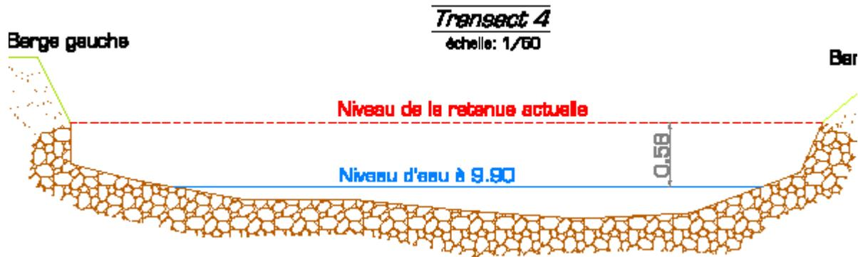
Figure 27 : Evolution de la cote de niveau d'eau en amont de l'ouvrage après aménagement
