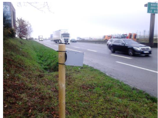
Figure 14 : Prélèvement par diffusion passive aux abords de la rocade de Rennes
