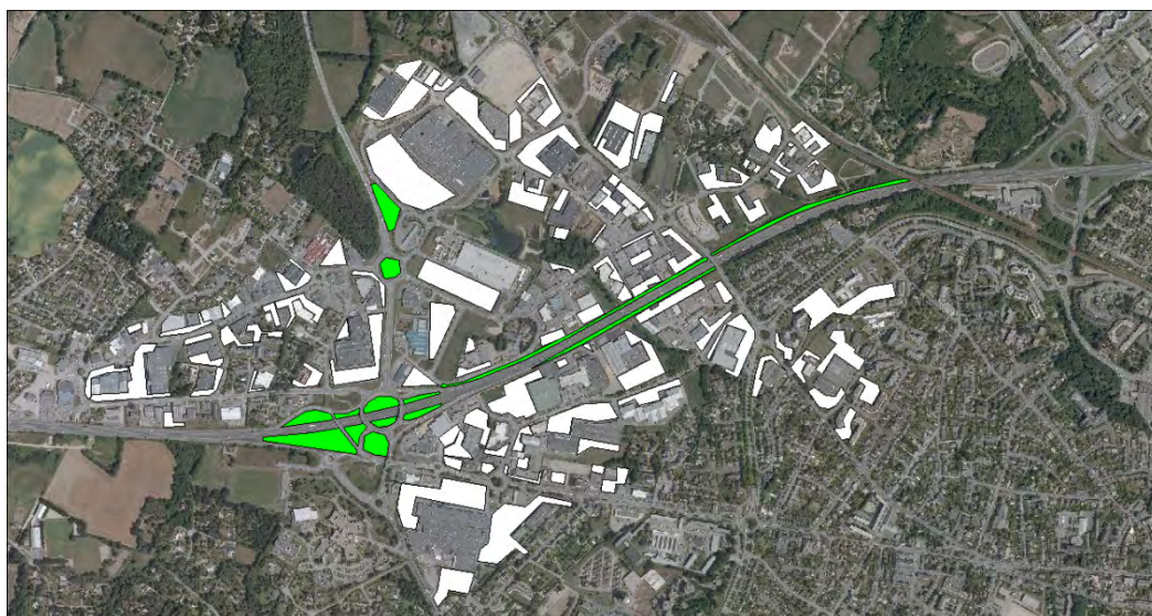
Identification des parkings (en blanc) et des délaissés routiers (en vert) pour l'installation de centrales photovoltaïques sur les ZA du Parc Lann, de Kerlann et de Luscanen.
