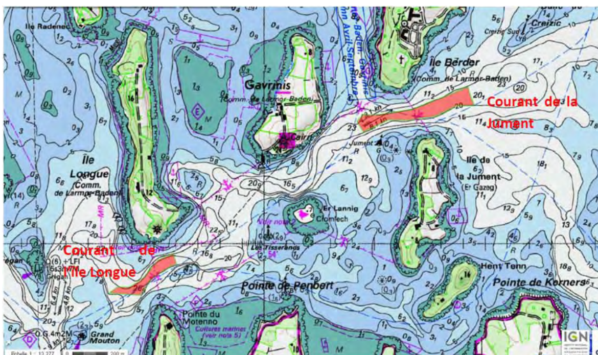
Carte des 2 zones présentant les courants les plus favorables pour l'installation d'hydroliennes Source : Etude du Potentiel hydrolien du Mor Braz - Conseil Général du Morbihan
