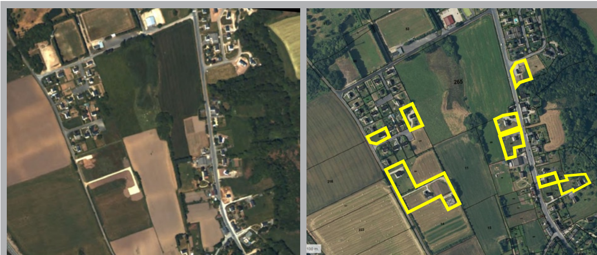
Méthode des photos aériennes : repérage et mesure des surfaces artificialisées sur un secteur de Meslan, ici entre 2004 (à gauche) et 2013 (à droite).
