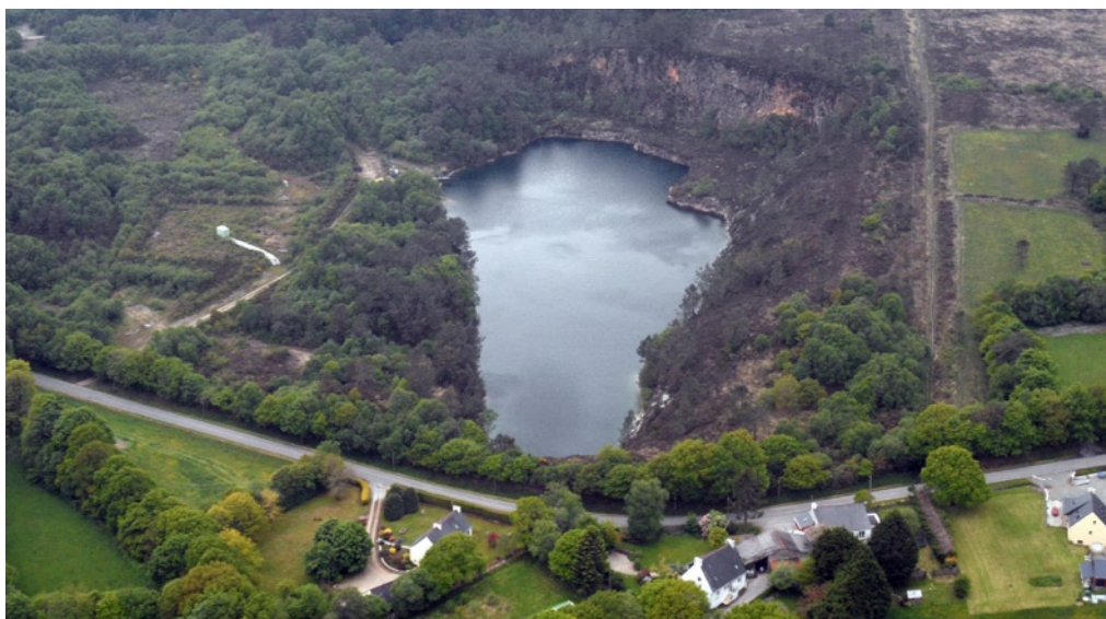
Les anciennes carrières de quartzite de Minez Cluon, près de Gourin, sont utilisées pour le stockage d'eau destinée à être potabilisée.
