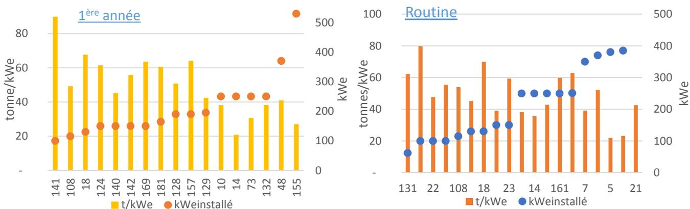
Fig 6 : Tonnage d'intrants au kWe installé
