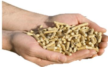
Figure 1 : Granulés de bois pour le chauffage domestique **[AFNOR, 2012]**.
