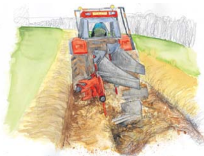
Exemple de talus à la charrue forestière (technique développée par Philippe Rolland).
