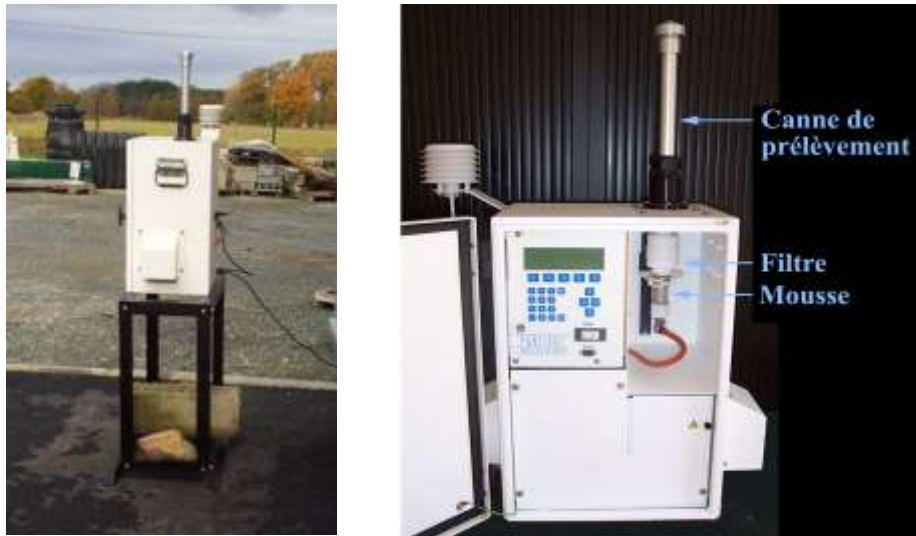
Figure 9 : Système utilisé pour prélever les pesticides dans l'air
