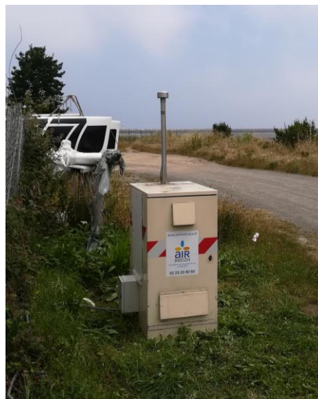
Figure 10 : Cabine contenant l'analyseur \text{H}_2\text{S}
