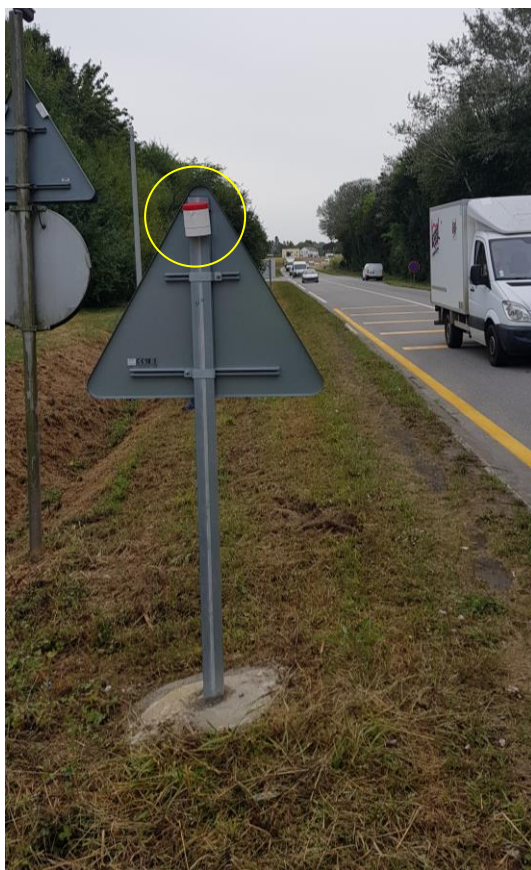
Figure 1 : Tube passif sur l'un des points (point 'N0' à Noyal-Châtillon-sur-Seiche)
