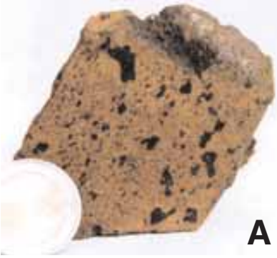
Figure 52 - A - Lave massive, altérée et vacuolaire. B. Photographie de lame mince (lumière naturelle). Pl : plagioclase, Ch : chlorite, Ox : oxydes ferro-titanés.
