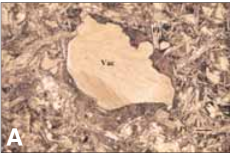
Figure 48 - Photographies de lames minces d'un pillow lava de la carrière de Rosan. A. texture microlitique et amygdalaire (les amygdales sont d'anciennes bulles de gaz remplies de calcite hydrothermale secondaire). B. Vacuoles et "fantômes" d'olivine automorphe pseudomorphosés par la calcite et les oxydes de fer. Vac : vacuole, ol : "fantôme" d'olivine, pl : microlite de plagioclase.
