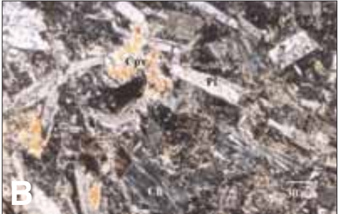
Figure 51 - A. Aspect de l'affleurement de diabase schistosée, au fond de l'anse de Garvan. B. Photographie de lame mince montrant sa texture intersertale. Pl : lattes de plagioclase, Ch : amas de chlorite, Cpx : cristaux de clinopyroxène.
