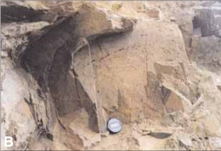
Figure 47. A. Vue générale de la carrière de Rosan. B. Morphologie d'un pillow lava à amygdales concentriques dans la carrière de Rosan.
