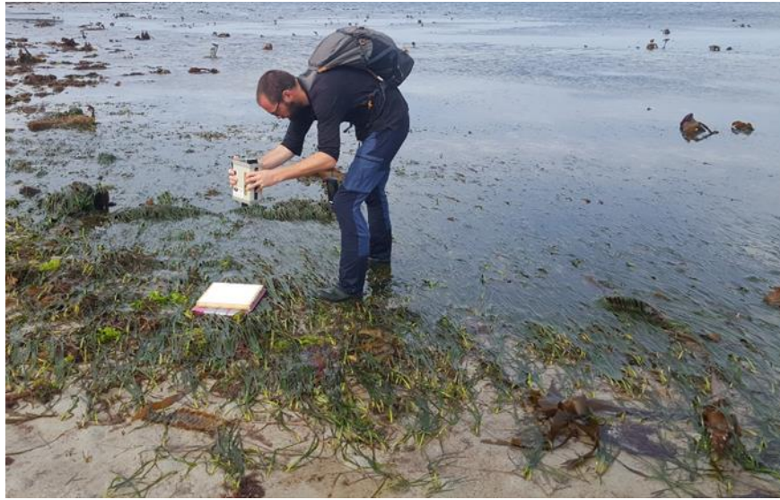
Figure 110 Utilisation du spectroradiomètre GER 1500 et du spectralon sur le terrain
