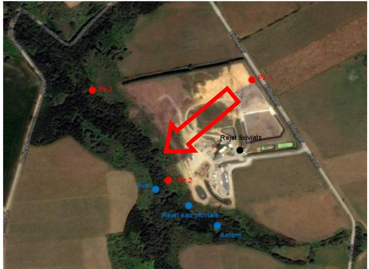
**Le calcul du sens de l'orientation de la nappe (entre 234 et 237° par rapport au nord) nous montre que c'est bien le piézomètre n°2 qui est le plus représentatif de l'impact du site sur son environnement.**
