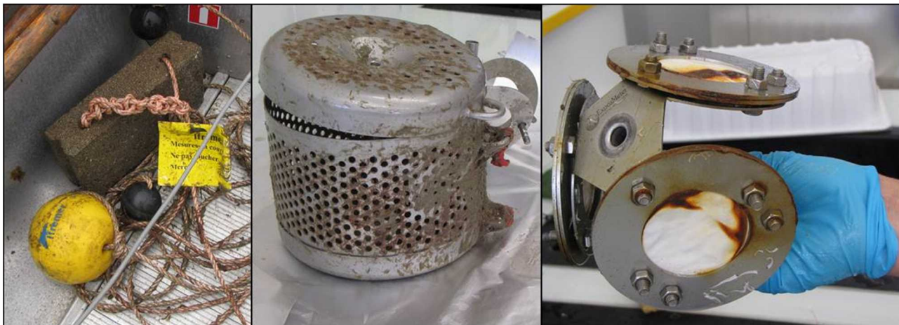
Ligne de mouillage, cage et support du triplicata POCIS
