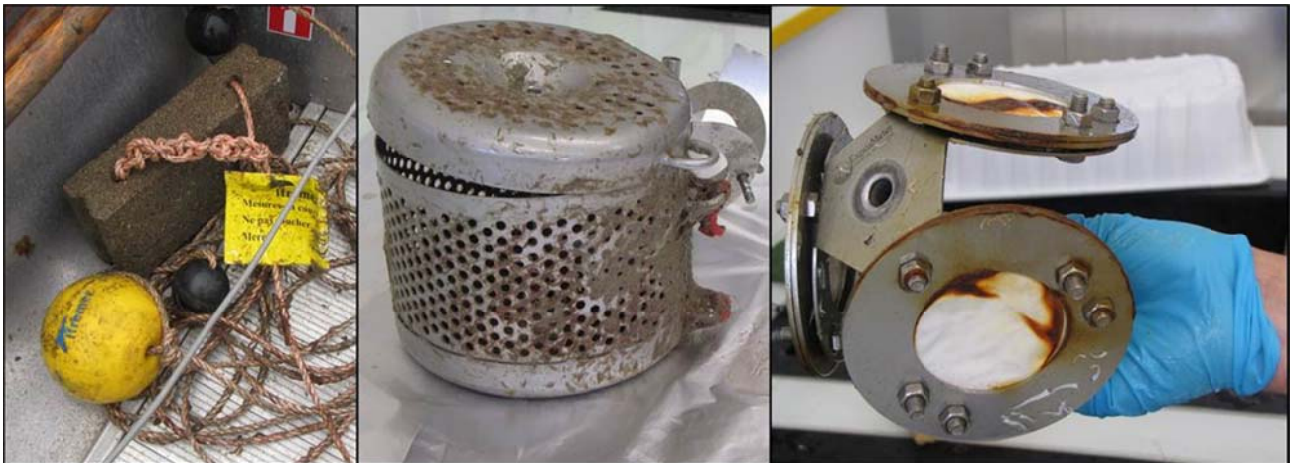
Ligne de mouillage, cage et support du triplicata POCIS
