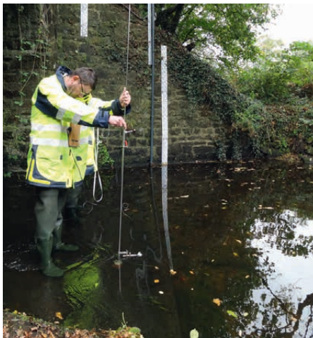
Jaugeage réalisé par la DREAL Bretagne sur l'Ellé à Ty Nadan le 12/10/2017
