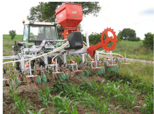
La bineuse est un outil de désherbage mécanique qui évite l'utilisation de désherbants chimiques sur maïs.
