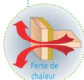
Un **soin particulier** doit être apporté pour **limiter au maximum les ponts thermiques** (et désordres associés) inévitablement accentués par l'isolation.
