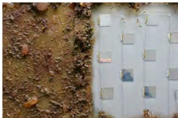
Comparaison de fouling avec la solution UV d'Akzo Nobel et Philips
