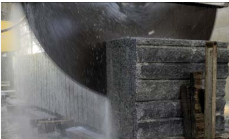
Fig. 4 - Taillage des extrémités des monolithes à la scie diamantée (La Générale du Granit).
