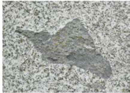
c - Monolithe A2, face Nord La longueur de cette enclave est de 17 cm.
