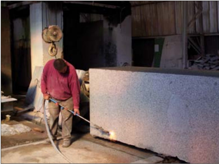
Fig. 5 - Flammage des faces des monolithes (La Générale du Granit).
