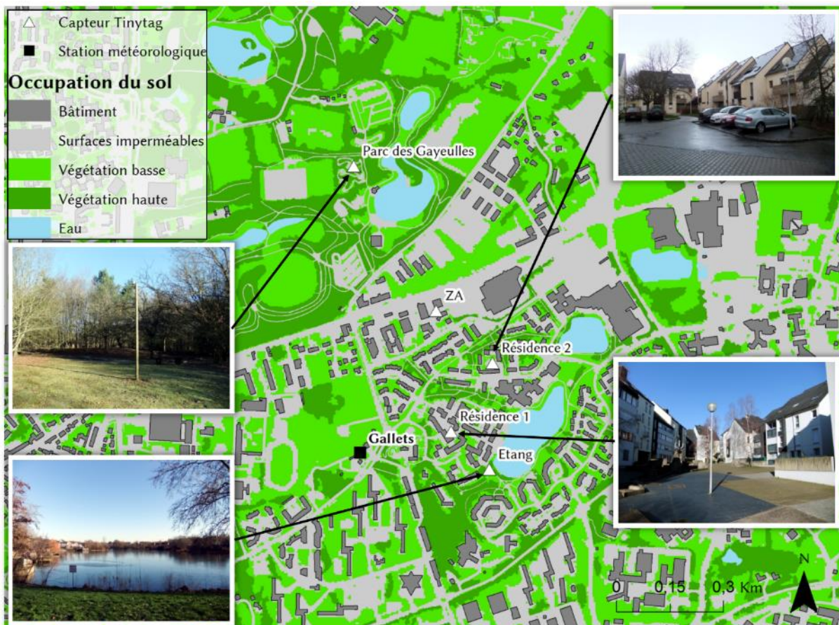
Figure 34, réseau de capteurs Tinytag installés à l'échelle de la ZAC Les Longs Champs. Photographies : Foissard X., janvier et février 2012.
